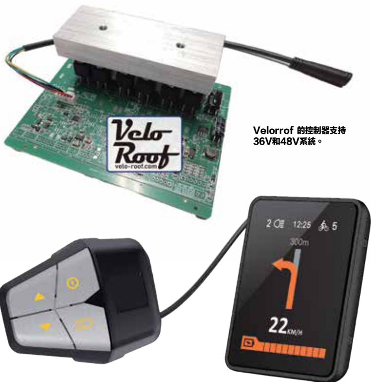
AVS 的 RC8-FS HMI 可與該公司的 CD9 顯示器搭配使用。
